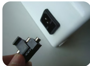
Sustituir fusible 0,5A. Existe un fusible de repuesto.
