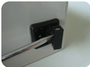
Con un destornillador o similar sacar la lengüeta del fusible.
